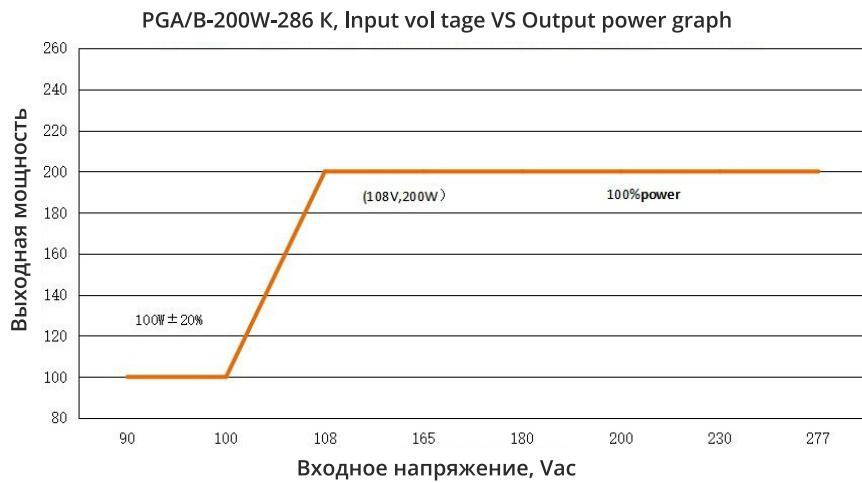
Для выходного напряжения 286 В. постоянный ток, номинальный выходной ток и мощность при различном входном напряжении
