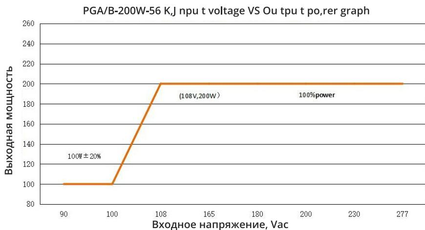
Для выходного напряжения 56 В. постоянный ток, номинальный выходной ток и мощность при различном входном напряжении
