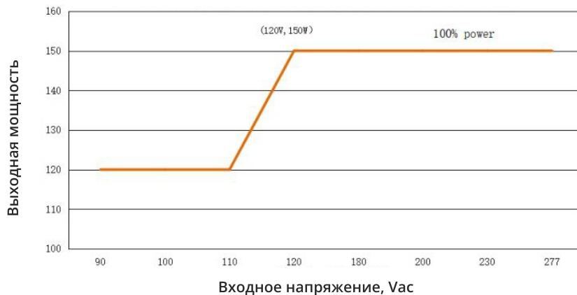
Для выходного напряжения 56 В. постоянный ток, номинальный выходной ток и мощность при различном входном напряжении
