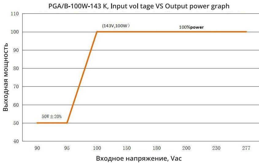
Для выходного напряжения 56 В. постоянный ток, номинальный выходной ток и мощность при различном входном напряжении
